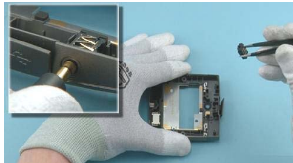
34) Use the AV plug to lift up the AV jack and remove it with tweezers.
